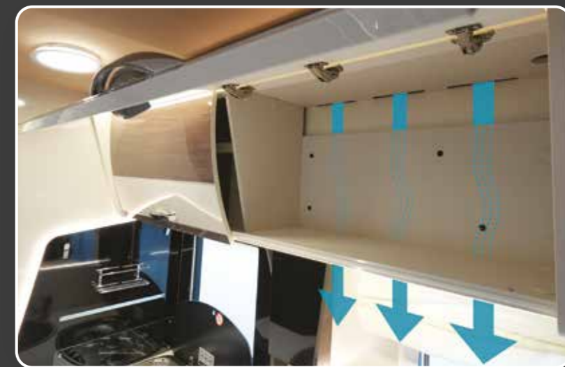
Door het ventilatiesysteem heb je een goede verdeling van de warmte en vermijd je condensatie.
