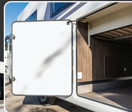
Fietsengarage met sjoorhaken (laadvermogen tot 300 kg)
